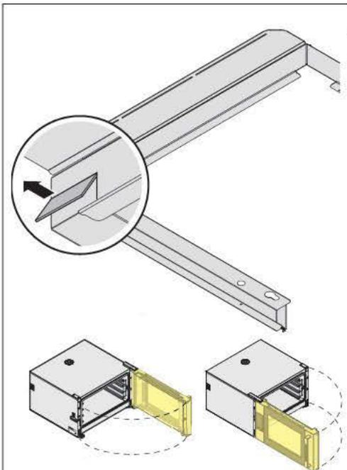
Se il forno sottostante al kit ha apertura a libro è necessario rimuovere la placchetta destra o sinistra del kit di sovrapposizione (in base al verso dell'apertura del forno) per creare lo spazio necessario alla cerniera superiore del forno.
